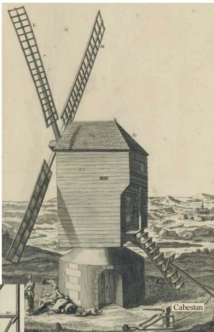
Le moulin à pivot tel qu'il est représenté dans l'Encyclopédie de Diderot et d'Alembert.
